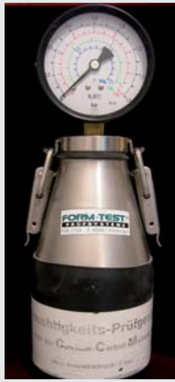
Abb. 1: Druckflasche zur Messung des Gasentwicklung beim CM-Verfahren.
