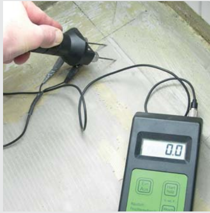
Abb. 2: Beispiel eines Widerstandsmessgerätes bei der Oberflächenmessung mit Nadelelektroden.
